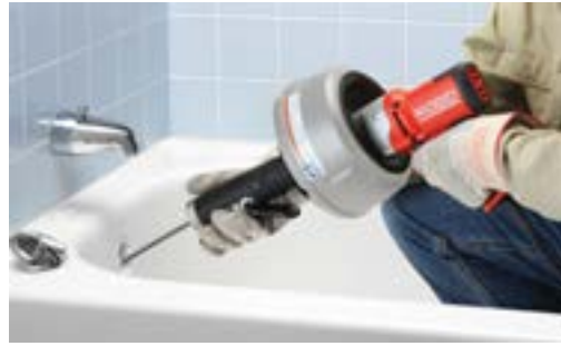
Το μοντέλο K-45AF αποφράσσει γρήγορα τους βουλωμένους αγωγούς. Προώθηση και απόσυρση σπирάλ χωρίς αντιστροφή του μοτέρ.
