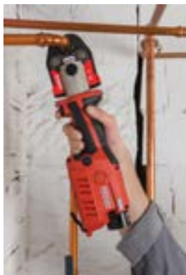
Σιαγόνες σειράς compact για σωλήνες χαλκού, ατσάλιου, ανοξείδωτου ατσάλιου, PEX και πολυστρωματικούς σωλήνες. Βλ. σελίδα 10.7
