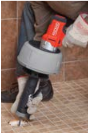
Το σπирάλ 3/8" (10 mm) στο μοντέλο K-45AF-5 επεκτείνει τη δυνατότητα του μηχανήματος σε αγωγούς αποχέτευσης 2 1/2" (75 mm).
